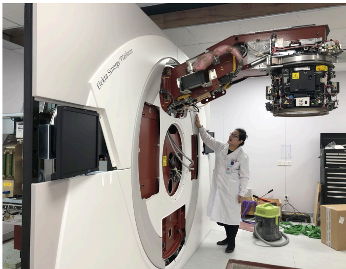
⑦ 徐向英参与直线加速器安装全程
